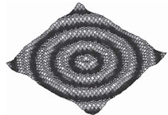
Рис. 4.1. Ведущий центр, или пейскекер, в возбудимой среде (подробнее см. учебник [75] и сборник трудов [155])
