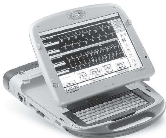
Рис. 11.3. Программатор Medtronic/Vitatron CareLink® 2090. С помощью программатора считываются и сохраняются на дискету накопленные кардиомонитором диагностические данные и осуществляется программирование функций и параметров устройства и активатора пациента
