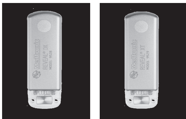
Рис. 11.1. Имплантируемые кардиомониторы Reveal® DX и Reveal® XT. Устройство представляет собой небольшой прибор прямоугольной формы (вес 17 г, размеры 61 x 19 x 8 мм) с двумя электродами, расположенными непосредственно на поверхности корпуса
