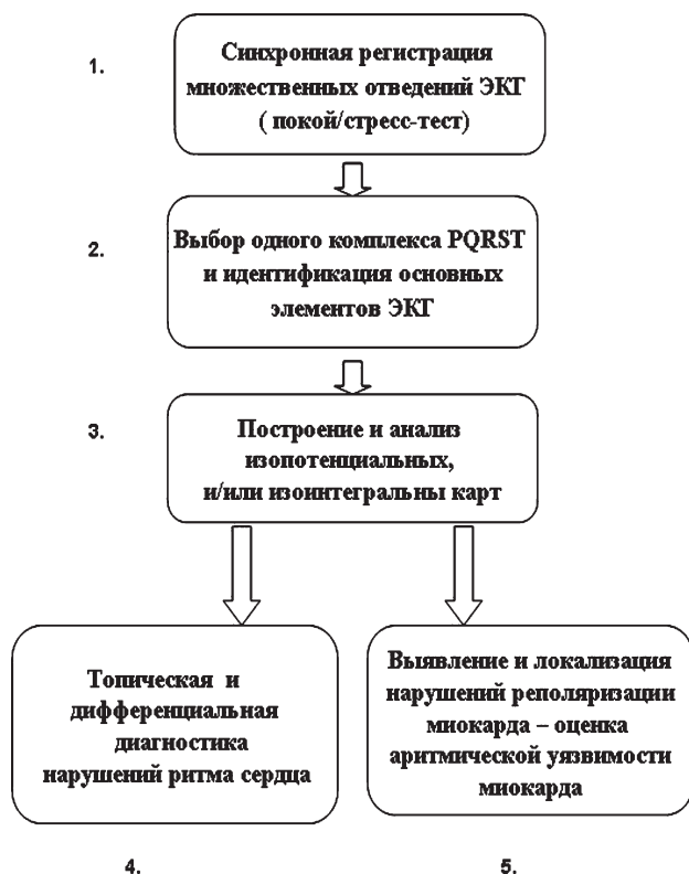
Рис. 6.7. Алгоритм анализа данных поверхностного ЭКГ-картирования при диагностике аритмий
